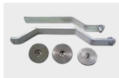
**Ci-dessus :** Gabarit de perçage conique, au milieu : Gabarit de perçage pour trou = Ø 8,5 mm, **ci-dessous :** Gabarit à visser pour tête de rivet = Ø 11 ou 14 mm pour appareil à riveter AccuBird (MBE)
