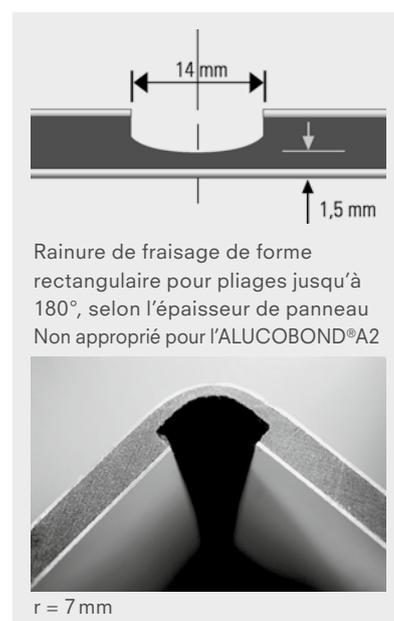
**Indication:** Dans le cas de l'ALUCOBOND® anodisé et de l'ALUCOBOND® naturAL Reflect, un léger éclaircissement apparaît dans la zone de pliage en raison de microfissures.
